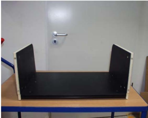
Den nächsten Schritt können Sie ausserhalb des Fahrzeuges vornehmen. Verbinden Sie zwei der Trennwände mit dem Microwellenboden mittels 3x Flachkopfschrauben M6x60. Die entsprechenden Quermuttern sind bereits im Boden vormontiert.
