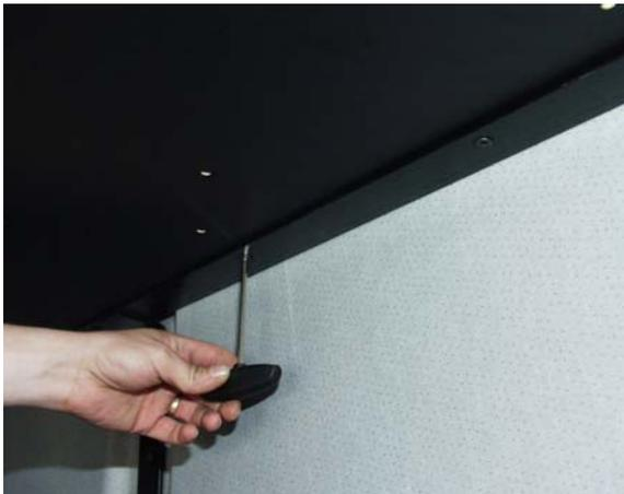
Stecken Sie durch die Löcher in der hinteren Metallauflage 6 x Innensechskantschrauben M6 x 30 und verschrauben diese von oben mit einer Unterlegscheibe und Stopmutter !
