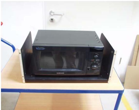
Das mittlere Fach ist für den Einbau einer Mikrowelle vorgesehen, die optional unter der Artikel-Nr.: **25309030001.4** erhältlich ist. Die Befestigungswinkel sind mit links bzw. rechts gekennzeichnet. Sie werden mit dem Boden mittels Sechskantschrauben M4x16 verbunden.
