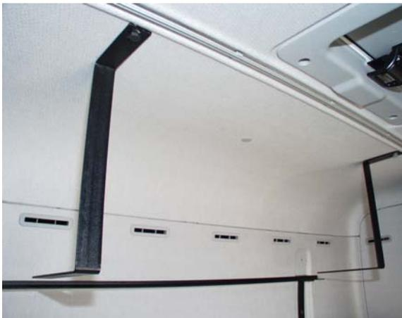
Montieren Sie die beiden vorderen Metallabhängungen im Fahrzeughimmel mit jeweils 1 x M10 x 25 .
