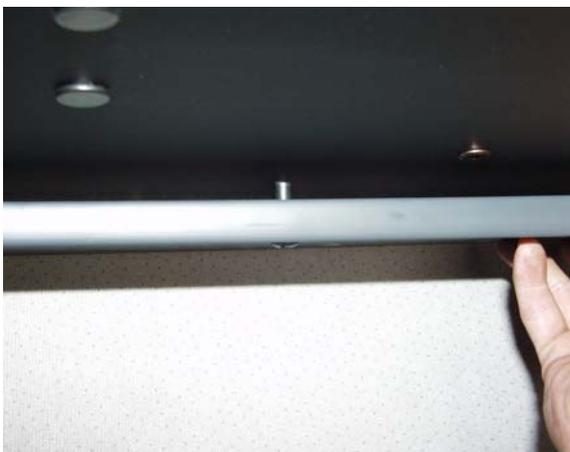
Verschrauben Sie die Abdeckblende für den hinteren Metallwinkel nun von unten mit der Bodenplatte. Verwenden Sie hierzu die schwarzen 2-teiligen Verbindungsschrauben 32-40 mm.
