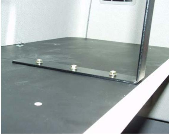
Verschrauben Sie die Bodenplatte mit den vorderen Metallabhängern pro Seite 3 x mit M6 x 20 Sperrzahnschrauben.
