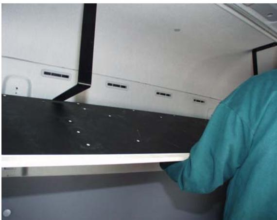
Heben Sie die Bodenplatte ins Fahrzeug und legen diese auf den hinteren Metallwinkel.
