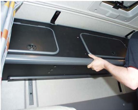
Heben Sie die Frontblende ins Fahrzeug und schieben diese schräg von unten gegen den Fahrzeughimmel. Klappen sie die Blende gegen den Boden und Trennwände und schieben Sie das PVC-Eckprofil den Falz.
