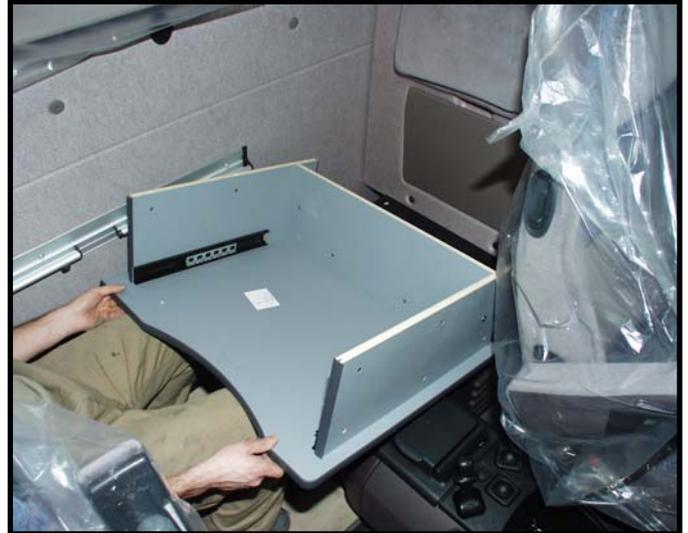
**Legen Sie nun den mittlern Zwischenboden auf die Seiten und verschrauben diese mit Flachkopfschrauben M6x60 fest.**
