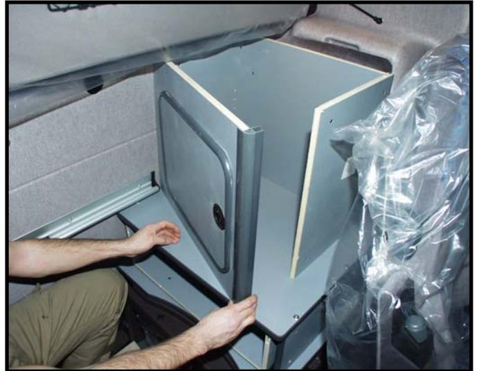
**Dann legen Sie die Deckelplatte auf den Schrank und verschrauben diese mittels Flachkopfschrauben M6x60 fest**
