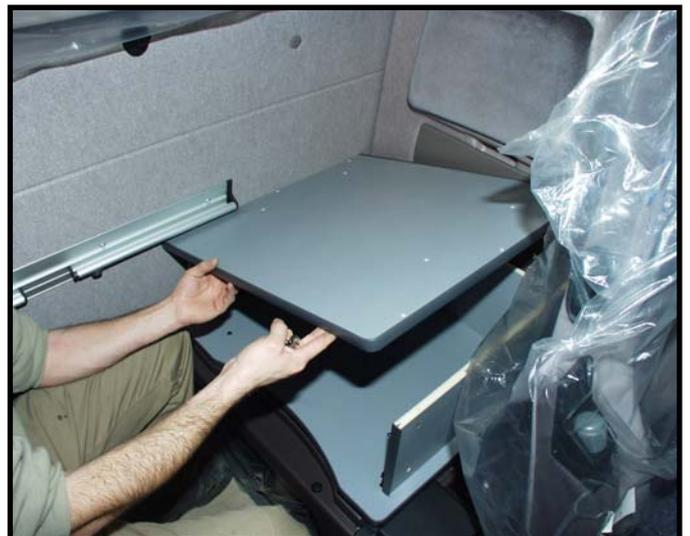
**Stellen Sie jetzt die Seiten und die Rückwand auf den Zwischenboden und verschrauben diese von unten mit Flachkopfschrauben M6x60 fest.**
