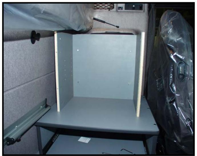
**Stellen Sie als nächstes die Frontblende vor die Seitenwände und schieben rechts das Eckprofil auf die linke Seitenwand. Anschließend verschrauben Sie das Eckprofil von innen mit Spax-Schrauben 3,5x16 an die Seitenwand fest.**
