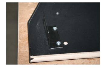
Stellen Sie die mittlere Blende auf die Bodenplatte und fixieren die Winkel mit den Löchern auf die Rampamuffen der Bodenplatte, und verschrauben die mittels M4 x 8mm Flachkopfschraube.
