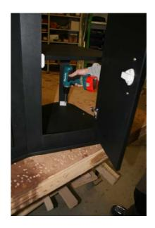
Legen Sie den Mikrowellenboden in das mittlere linke Fach und verschrauben den mittels M6 x 60mm Flachkopfschrauben fest.
