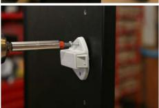
Drücken Sie den Griff in den Zapfen und schrauben den mittels M4x30mm Flachkopfschraube fest.
