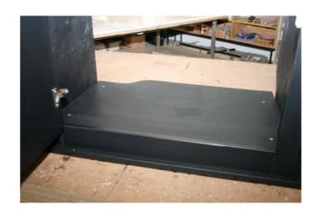
Stellen Sie die seitlichen Blenden links und rechts auf die Bodenplatte und verschrauben die Blenden mit dem Schrank mittels M4 x 8mm Schrauben.
