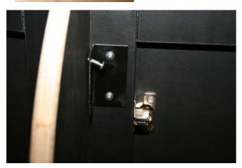
Stecken Sie die Deckelplatte zwischen die Blenden und den oberen Winkel, fixieren die Löcher und verschrauben die Deckelplatte mittels M4 x 8mm Flachkopfschrauben.
