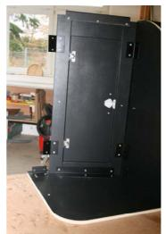
Verschrauben Sie mittels M4 x 8mm Flachkopfschraube und Verbindungshülse die Blenden mit der Trennwand.
