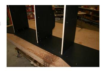
Schrauben Sie links und rechts auf der Bodenplatte die dafür vorgesehenen Winkel mittels M4 x 8mm Flachkopfschrauben fest.
