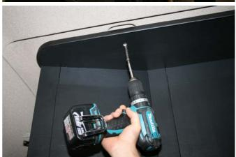
Verschrauben Sie die Auflagewinkel seitlich und hinten mit der Bodenplatte mittels M6 x 30mm Flachkopfschraube, Scheibe und Stoppmutter zusammen.
