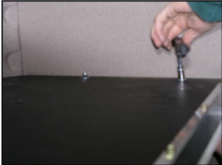
**Stellen Sie die Mitteltrennwände auf die Bodenplatte und verschrauben diese mittels M 6x60 Flachkopfschrauben von unten. Verschrauben Sie den Boden mittels Flachkopfschrauben M6 x 60 von rechts und von links durch die Trennwände. Die Montage einer Mikrowelle ist möglich, jedoch nicht im Lieferumfang enthalten.**
