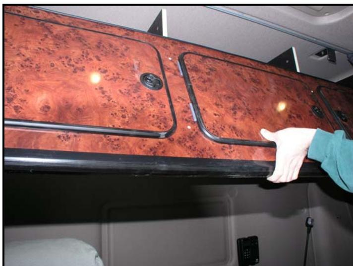
**Verschrauben Sie die Blende mit den Winkeln im Fahrzeughimmel mittels 4x Linsenkopfschrauben M6 x 30 von vorne mit U-Scheibe und Stopmutter.**
