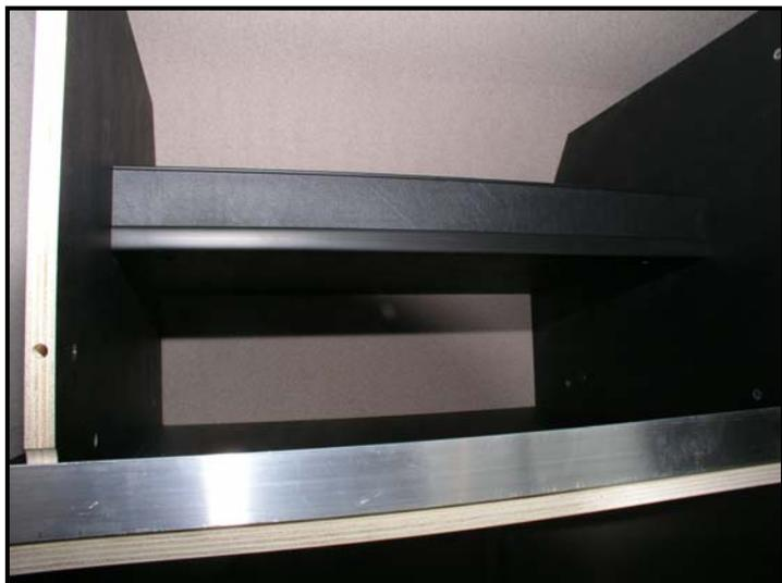
**Montieren Sie die Winkel mit den Original Schrauben im Fahrzeughimmel.**
