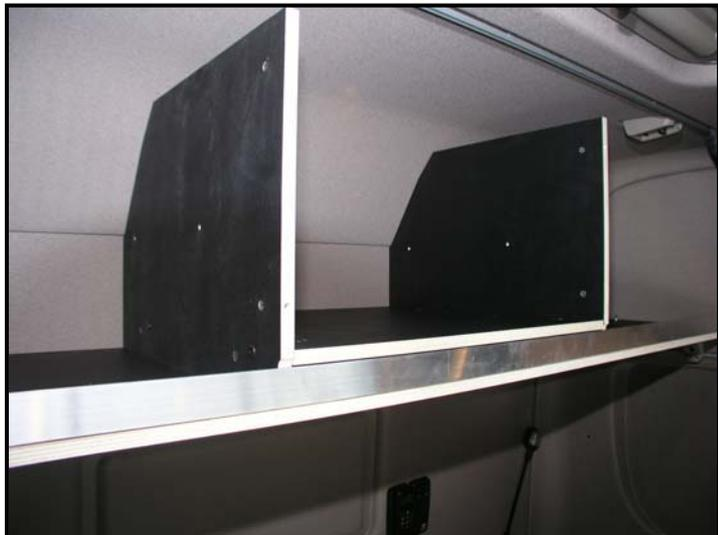
**Stellen Sie die Außenwände auf die Bodenplatte. Montieren Sie die Einlegeböden rechts und links und verschrauben diese mittels M6 x 60 durch die Außen- und Mittelwände.**
