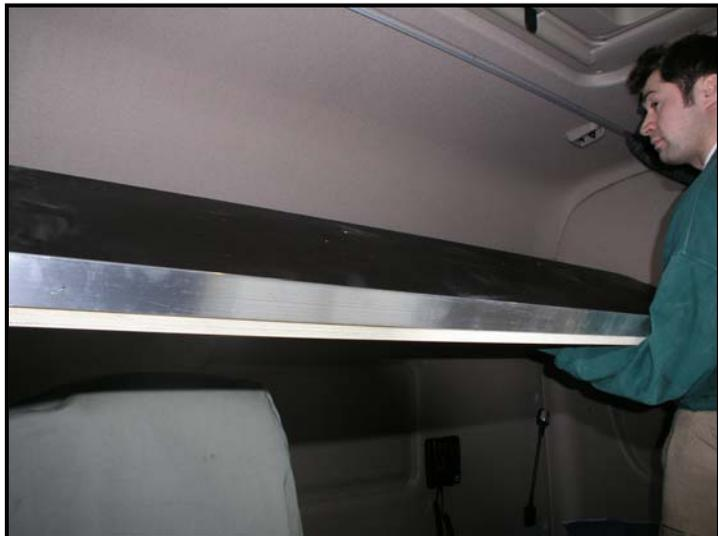
**Verschrauben Sie die Bodenplatte mit den Winkeln mittels 4 x Linsenkopfschraube M6 x 30 von unten und setzen oben eine U-Scheibe und Stopmutter.**
