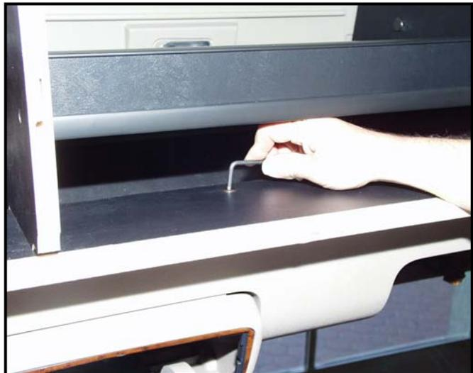
**An den Außenseiten verschrauben Sie die Bodenplatte jeweils mit 1 x Flachkopfschraube M6x60 von unten.**
