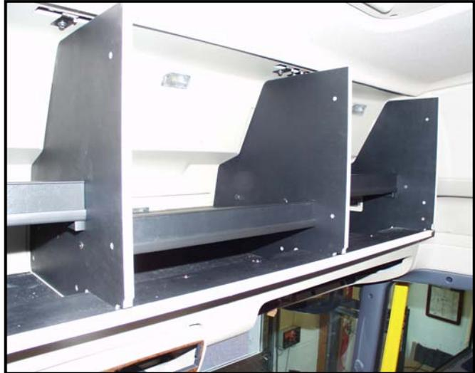
**Verschrauben Sie nun die Bodenplatte mit 5 x Flachkopfschraube M6x60 in die original Schraublöcher der Kunststoffverkleidung.**
