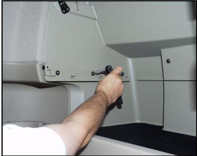
**Demontieren Sie die original Staufachklappen.**
