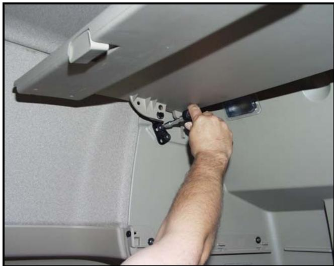
**Demontieren Sie das Inlett vom Staufach über dem Beifahrersitz.**
