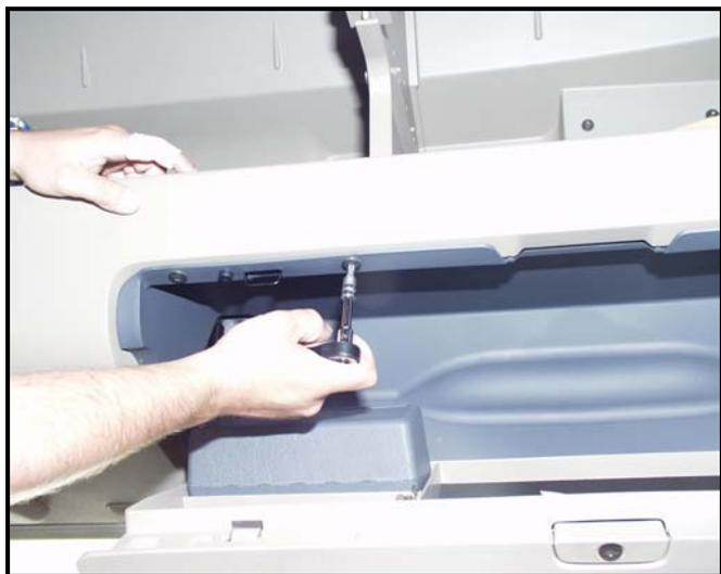
**Nachdem Sie das Inlett demontiert haben können Sie die original Mitteltrennwände von unten demontieren.**
