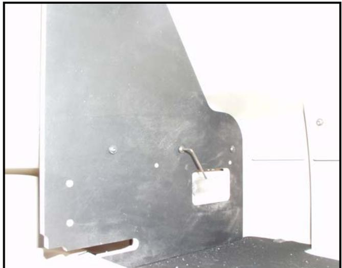
**Stellen Sie die Mitteltrennwände auf den Boden und verschrauben diese von unten durch die original Löcher mittels jeweils 2 Flachkopfschrauben M6x60. Siehe nächstes Bild**
