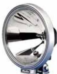
Fernscheinwerfer mit Positionslicht (W5W), schwarzes Kunststoffgehäuse mit silbergrauem Ring, High Boost Reflektor, ohne Leuchtmittel (H1), 12/24V, Einbautiefe 126 mm, Hella Nr. 1F8 006 800-311
