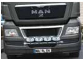
alle Modelle mit Kunststoffstoßstange, 63 mm Rohr, mit 3 weißen LEDs, mit 4 Scheinwerferhalterungen, vorverkabelt für 4 Fernscheinwerfer, Montage ohne bohren, in Edelstahl hochglanzpoliert oder Aluminium eloxiert - LED Beleuchtung nach STVZO nicht zulässig
