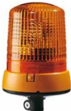
Lichthaube & Gehäuse in gelb, mit flexibler Rohrstützenbefestigung für Aufsteckrohr, mit H1 Glühlampe, Drehzahl 160 U/min, Funkenstörung: Leistungsgeführt Klasse 5, Leistungsaufnahme Glühlampe 70W, Gesamtstromaufnahme 3,5A, 24V, Hella Nr. 2RL 008 063-111
