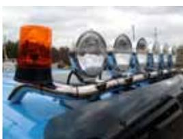
M & L, mit 5 weißen LEDs, mit 4 Scheinwerferhalterungen, vorverkabelt für 4 Fernscheinwerfer und 2 Rundumleuchten, 63 mm Rohr, in Edelstahl hochglanzpoliert oder Aluminium eloxiert - LED Beleuchtung nach STVZO nicht zulässig
