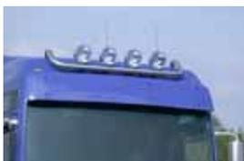
breites Fahrerhaus Hochdach "De Luxe" 60 mm Rohr, inkl. 4 Scheinwerferhalterungen (Schellen verschiebbar) zur Montage auf dem Dach, es muss ins Dach gebohrt werden! (Ohne Verkabelung)
