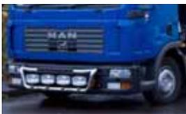
mit 1 seitlichen Trittstufe & Kunststoffstoßstange, 63 mm Rohr, mit 3 weißen LEDs, mit 4 Scheinwerferhalterungen, verkabelt für 4 Fernscheinwerfer rund (z.B. Hella Compact Modelle) oder eckig (Hella Jumbo 320 oder 220), in Edelstahl hochglanzpoliert oder Aluminium eloxiert- LED Beleuchtung nach STVZO nicht zulässig
