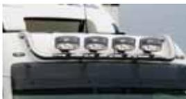
LX, mit 3 weißen LEDs vorn und je 1 orangenen seitlich, mit 4 Scheinwerferhalterungen, vorverkabelt für 4 Fernscheinwerfer und 2 Rundumleuchten, 63 mm Rohr, in Edelstahl hochglanzpoliert oder Aluminium eloxiert - LED Beleuchtung nach STVZO nicht zulässig
