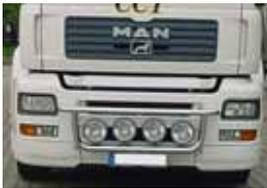
mit Kunststoffstoßstange, 60 mm Rohr mit Haltevorrichtung für 4 Scheinwerfer. (Ohne Verkabelung). Abschleppöse nicht mehr frei zugänglich!
