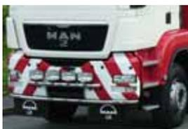
Baustellenfahrzeug mit großer Stahlstoßstange, 63 mm Rohr, mit 3 weißen LEDs, mit 4 Scheinwerferhalterungen, vorverkabelt für 4 Fernscheinwerfer, Montage ohne bohren, in Edelstahl hochglanzpoliert oder Aluminium eloxiert - LED Beleuchtung nach STVZO nicht zulässig
