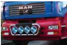
Baustellenfahrzeug, 63 mm Rohr, mit 4 Scheinwerferhalterungen, mit Aufstieg, verkabelt für 4 Fernscheinwerfer (Ø220 mm), Montage von Hella Luminator nur mit Adapterplatte möglich! In Edelstahl hochglanzpoliert oder Aluminium eloxiert
