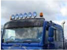
mit 5 weißen LEDs, mit 4 Scheinwerferhalterungen, vorverkabelt für 4 Fernscheinwerfer und 2 Rundumleuchten, 63 mm Rohr, in Edelstahl hochglanzpoliert oder Aluminium eloxiert - LED Beleuchtung nach STVZO nicht zulässig
