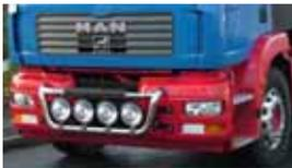
Baustellenfahrzeug mit Stahlstoßstange, 63 mm Rohr, mit 3 weißen LEDs, mit 4 Scheinwerferhalterungen, vorverkabelt für 4 Fernscheinwerfer rund (z.B. Hella Compact Modelle) oder eckig (Hella Jumbo 320 oder 220) in Edelstahl hochglanzpoliert oder Aluminium eloxiert - LED Beleuchtung nach STVZO nicht zulässig
