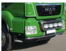
Baustellenfahrzeug mit großer Stahlstoßstange, passt nicht für Euro 6, vorverkabelt, mit 5 weißen LEDs, in Edelstahl hochglanzpoliert oder Aluminium eloxiert - LED Beleuchtung nach STVZO nicht zulässig
