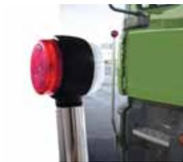
mit Begrenzungsleuchte rot/weiß 12-24V, für universelle Montage, Neigung am Fuß einstellbar, Beleuchtung nach StVZO nicht zulässig. Die zulässige Gesamtbreite des Fahrzeuges kann durch die Montage überschritten werden
