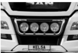
mit Kunststoffstoßstange, 63 mm Rohr, mit 4 Scheinwerferhalterungen, verkabelt für 4 Fernscheinwerfer (z. B. Hella Rallye 3000) in Edelstahl hochglanzpoliert oder Aluminium eloxiert - LED Beleuchtung nach STVZO nicht zulässig
