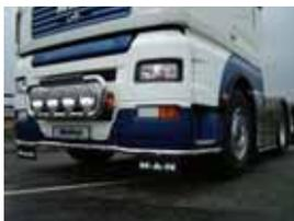
mit Kunststoffstoßstange, alle Modelle außer Baufahrzeuge, 63 mm Rohr, mit 4 Scheinwerferhalterungen, mit Aufstieg, verkabelt für 4 Fernscheinwerfer (Ø220 mm), Montage von Hella Luminator nur mit Adapterplatte möglich! In Edelstahl hochglanzpoliert oder Aluminium eloxiert
