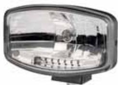
Fernscheinwerfer mit LED Positionslicht, schwarzes Kunststoffgehäuse, Klarglas, ohne Leuchtmittel (H7), Anbau stehend oder hängend, 12/24V, Hella Nr. 1FE 008 773-081
