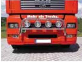
XLX mit Kunststoffstoßstange, 60 mm Rohr mit Haltevorrichtung für 4 Scheinwerfer. (Ohne Verkabelung). Abschleppöse nicht mehr frei zugänglich!
