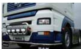
passend für alle TGA Modelle mit Kunststoffstoßstange, außer Baufahrzeuge, vorverkabelt, mit 7 weißen LEDs vorne und je 2 orangenen LED seitlich, in Edelstahl hochglanzpoliert oder Aluminium eloxiert - LED Beleuchtung nach STVZO nicht zulässig
