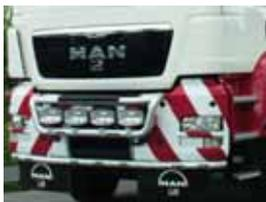
Baustellenfahrzeug mit großer Stahlstoßstange, 63 mm Rohr, mit 4 Scheinwerferhalterungen, vorverkabelt für 4 Fernscheinwerfer rund (z.B. Hella Compact Modelle) oder eckig (Hella Jumbo 320 oder 220), in Edelstahl hochglanzpoliert oder Aluminium eloxiert
