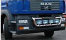
mit 2 seitlichen Trittstufen & Kunststoffstoßstange, 63 mm Rohr, mit 4 Scheinwerferhalterungen, verkabelt für 4 Fernscheinwerfer rund (z.B. Hella Compact Modelle) oder eckig (Hella Jumbo 320 oder 220), in Edelstahl hochglanzpoliert oder Aluminium eloxiert - passt nicht für Euro 6 Modelle
